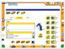
Standardfunktion bei Visual 3: Digitaler Vakuumschalter : Mit dieser Funktion programmieren und speichern Sie Ihre individuellen Vakuum-Greifereinstellungen für jedes Werkzeug.
