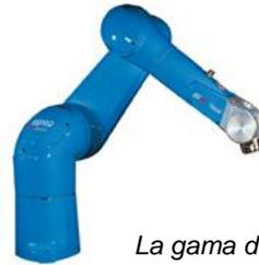
La gama de robots 6X Visual combina un robot de brazo articulado de 6 ejes Stäubli con un controlador Visual 3 de Sepro para ofrecer una solución multieje especialmente diseñada para el moldeo por inyección.
