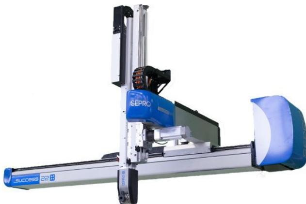
*Robot Success 22X, robot 5-axes avec une rotation numérique.*
