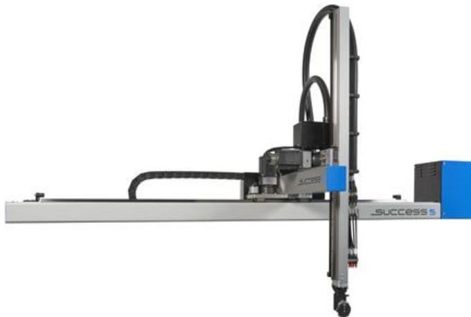
*Der Success 5 der neueste und kleinste Linear-Roboter von SEPRO ist wirtschaftlich, universell einsetzbar und bietet durch die 3-Achs-Servotechnik eine starke Leistung sowie eine hohe Genauigkeit auf Spritzgießmaschinen von 20 t – 80 t. Die Dateien in hoher Auflösung erhalten Sie hier:*
