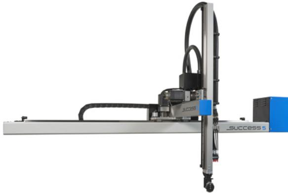
*Le nouveau Success 5, le plus petit modèle de la gamme des robots universels Success de Sevro, apporte la précision et les capacités d'un robot 3 axes servocommandé sur des presses d'injection allant de 30 à 80 tonnes. Téléchargez un fichier HD à l'adresse : <http://tinyurl.com/kpcp7tp>*
