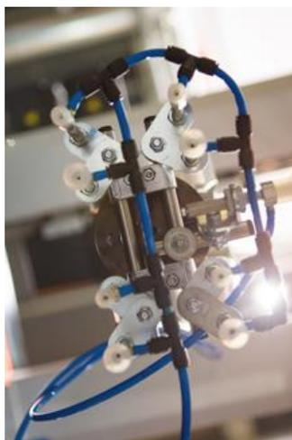
*El sistema “My Gripper” representa un enfoque único para el suministro de componentes de herramienta al final del brazo, incluidas piezas estructurales, ventosas, elementos de corte y una gama completa de accesorios de herramienta creados por Sepro y otros dos proveedores líderes: Gimatic y AGS.*
