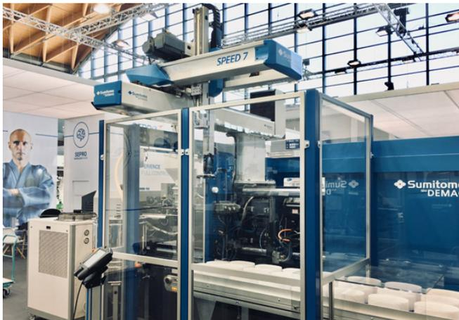
*Der Sepro S5-25 Speed verfügt über eine vertikale Z-Achse mit einer um 50 % höheren Hubgeschwindigkeit als beim Standardmodell.*
