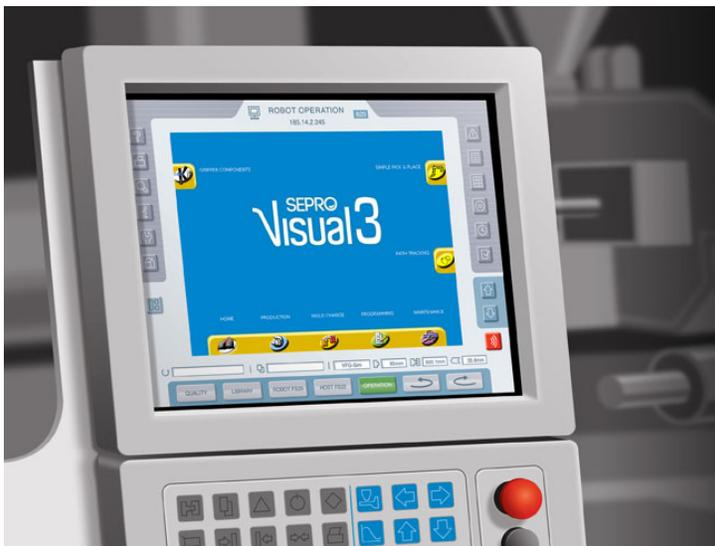
*L'« Open Integration » de Sepro permet d'afficher l'interface de commande du robot directement sur la presse. Téléchargez un fichier HD à l'adresse : <https://tinyurl.com/OpenIntegration>*
