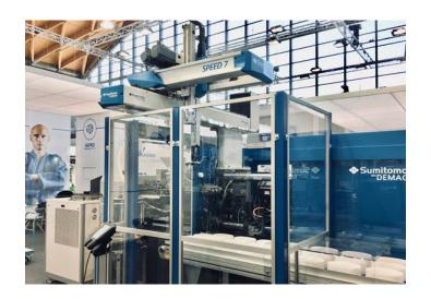
Sepro 展台上的两个自动化单元之一将采用住友德马格注塑机,该注塑机配备一台 SDR Speed 7 机械手。该机械手是 Sepro 专为搭配住友德马格注塑机而制造,可在 1 秒內进出容模空间。
