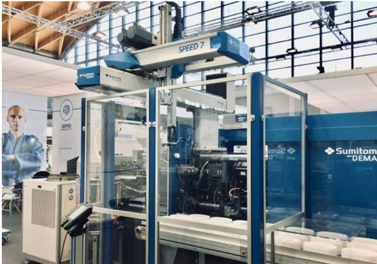
*Une des deux cellules d'automatisation présentes sur le stand Sepro comportera une presse d'injection Sumitomo Demag équipée d'un robot SDR Speed 7. Spécialement conçu par Sepro pour sa commercialisation avec des presses Sumitomo Demag, ce robot est capable d'entrer et de sortir du moule en moins d'une seconde.*
