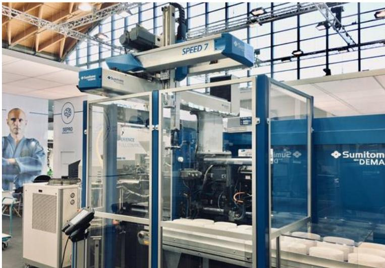
*Uma das duas células de automação no stand da Sevro apresenta uma máquina de moldagem Sumitomo Demag equipada com um robô SDR Speed 7. Produzido especialmente pela Sevro para venda em conjunto com as máquinas Sumitomo Demag, esse robô consegue entrar e sair de dentro do molde em menos de 1 segundo. Faça o download de um arquivo de alta resolução:*
