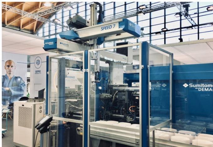
*Une des deux cellules d'automation présentes sur le stand Sepro comportera une presse d'injection Sumitomo Demag équipée d'un robot SDR Speed 7. Spécialement conçu par Sepro pour sa commercialisation avec des presses Sumitomo Demag, ce robot est capable d'entrer et de sortir du moule en moins d'une seconde.*
